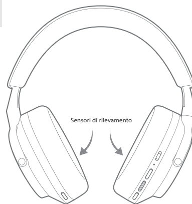
Diagramma 3 Ubicazione del sensore di rilevamento
